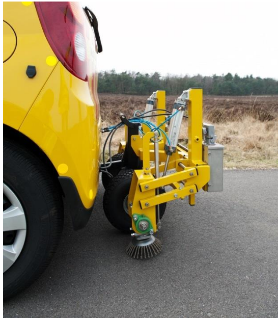
Figuur 2 Veeginstallatie FCM
